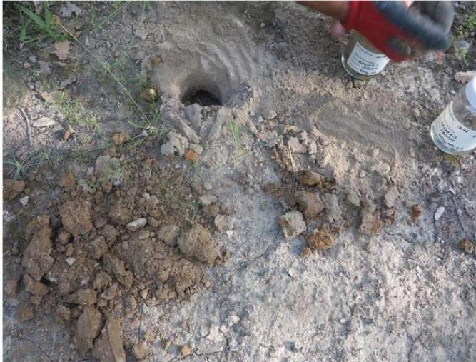
**Figure 44 : Résidus échantillonnés sur la laverie de Fressac. Les matériaux sont très fins, beige clair virant sur le brun en profondeur**
