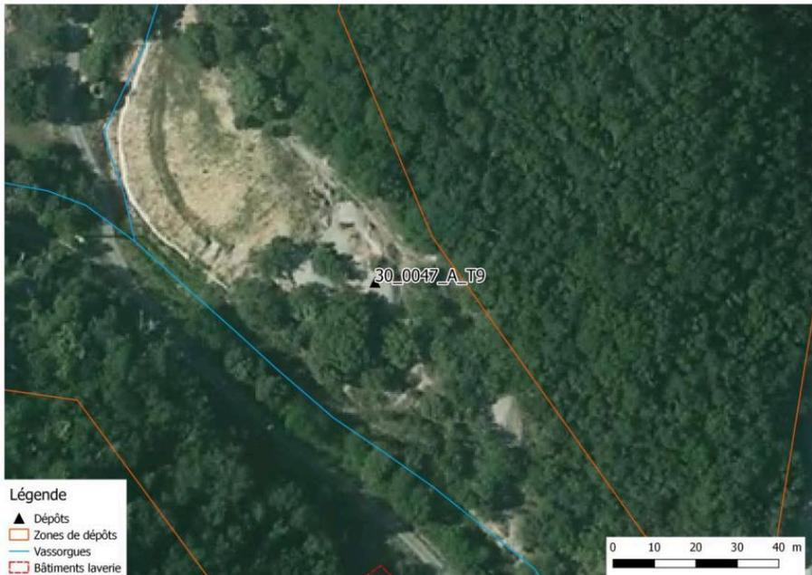
**Figure 87 : Localisation des haldes de laverie partiellement stabilisées sur le site de Lacoste (mur de soutènement, végétalisation)**
